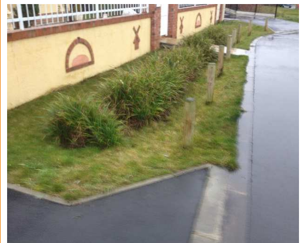
Figure 23 : Exemple de noue
